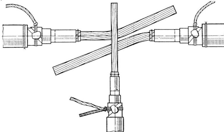
Рис. 4. Расположение концов кабелей при монтаже муфты МСТ в варианте «соединительная муфта».
