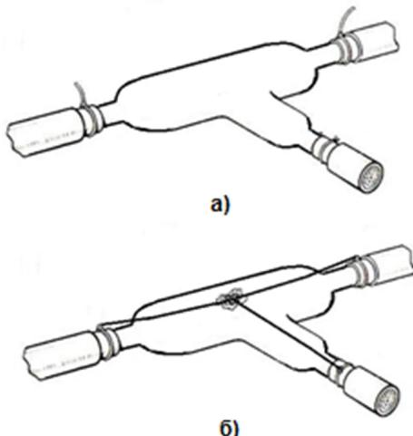
**Рис. 7. Монтаж муфты МСТ:**
