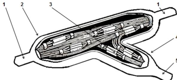
**Рис. 6. Муфта МСТ, полностью смонтированная:**
