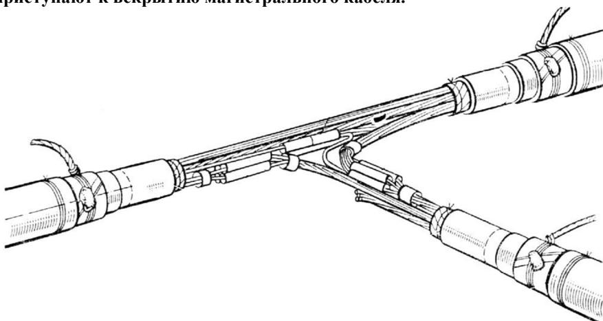
Рис. 5. Срашивание жил при монтаже муфты МСТ в варианте «врезная муфта».
