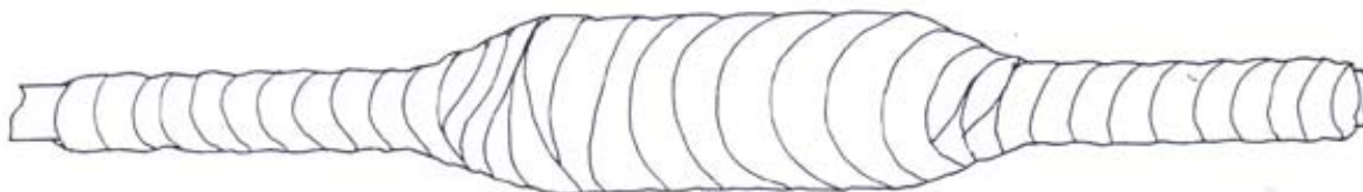
Рис. 7. Муфта МП-А-ТУТ обмотанная влагоотверждаемым бинтом «Армопласт», который должен перекрывать наружную ТУТ не менее чем на 30 мм по обе стороны от её концов.
